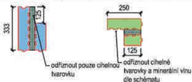
Detail řezání "párových" cihel v místě rohu
