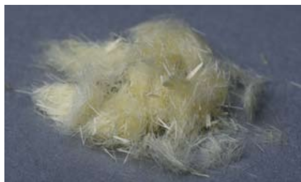
Aramidová vlákna, která jsou ve složení omítky, se používají např. v neprůstředních vestách.
